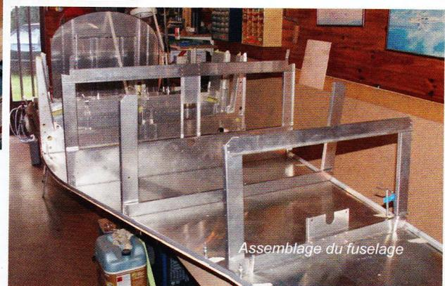
Assemblage du fuselage
