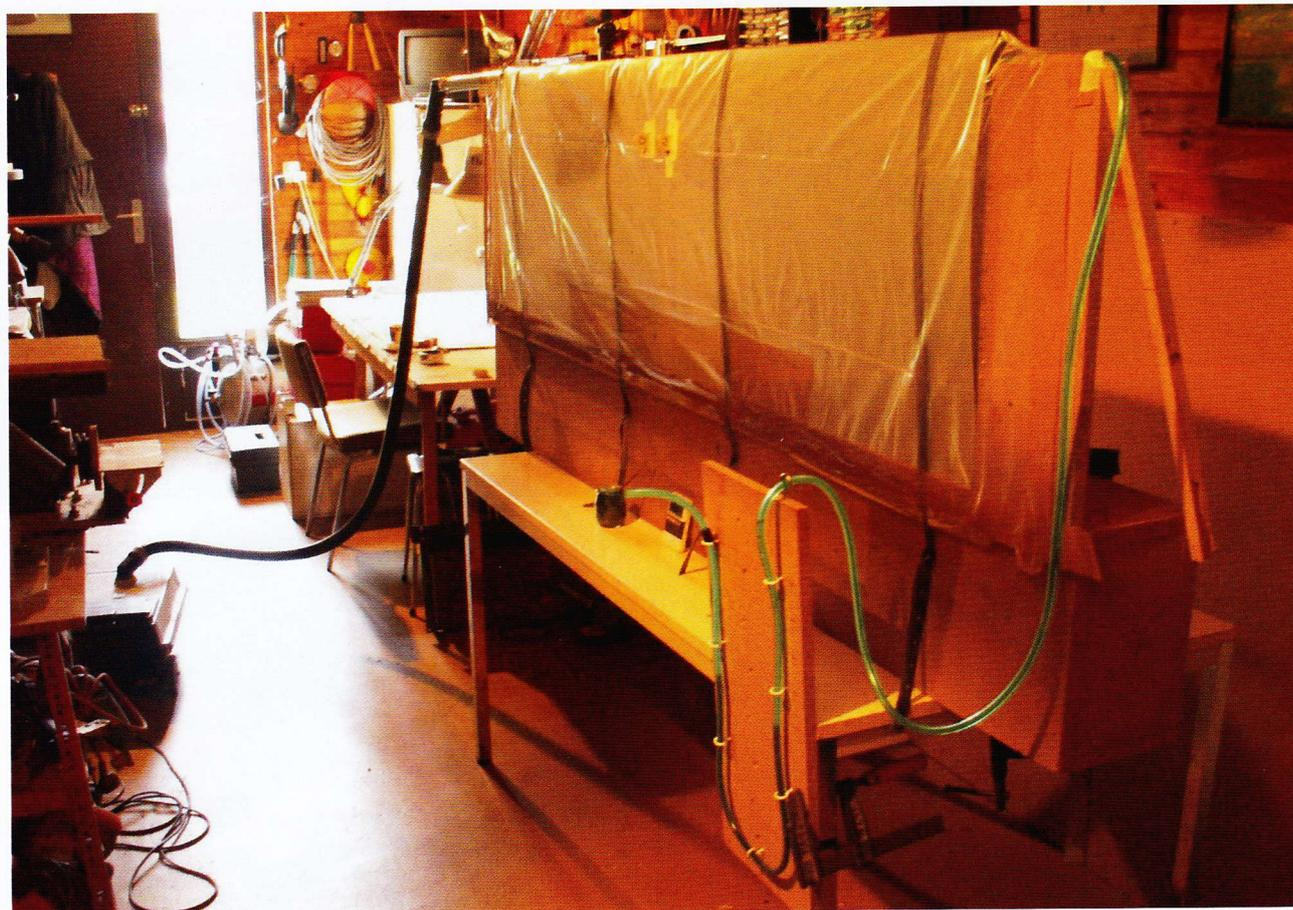
La dépression est contrôlée à l'aide d'un tube en plastique transparent positionné en « U » dont la partie basse est remplie de vin rouge (ou de n'importe quel autre liquide visible).
